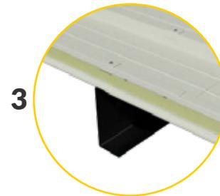
3 Proceda a hacer el traslape, colocando tornillos de fijación en todas las crestas del panel
